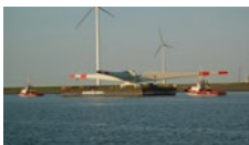
WAGENBORG BARGE 5 100 x 25,60 x 6,10 m. GT/NT: 4171/1251 draagvermogen: 9900 ton
