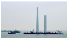
WAGENBORG BARGE 1 65,1 x 15,9 x 3,8 m. GT/NT 1002/300 draagvermogen: 2400 ton
